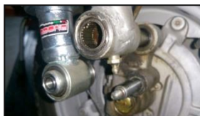
Centrare il perno del kit HTC al foro centrale della ruota, e riportare i perni ruota all'origine iniziale.
